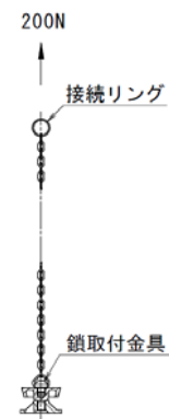
図3 鎖の引張強さ試験要領
